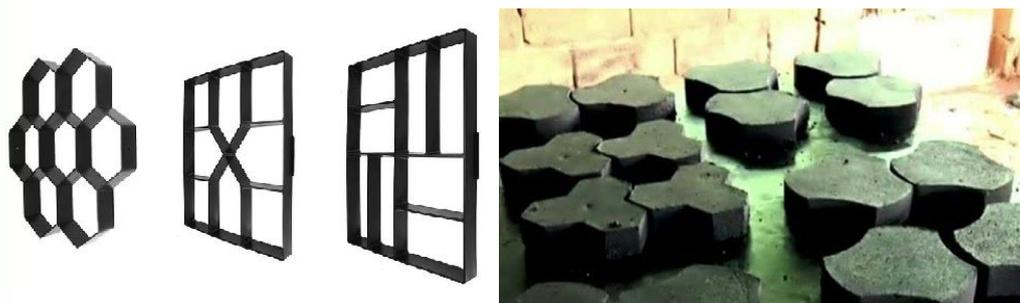
**Рис. 7. Формы и готовая полимерно-песчаная плитка**
